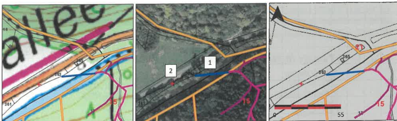
Plan de situation du franchissement (de gauche à droite : SCAN 25 ; ORTHOPHOTO ; PARCAD) avec en point 1 le franchissement et en point 2 la zone de stockage des bois le long de la RD39. Le magenta clair correspond à l'accès principal, le magenta foncé aux voies de débardage déjà existantes.
