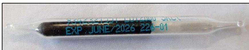
Figure 15 : Photographie du support de prélèvement à charbon actif (Hydrocarbures, COHV, BTEX) – ECR Environnement
