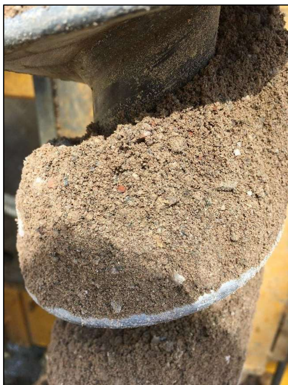
Figure 12 : Photographie des remblais trouvés au droit du sondage ST-PA-1 (ECR Environnement)
