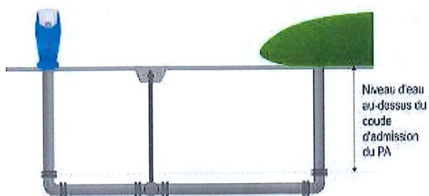
PA classique alimenté par une citerne souple
